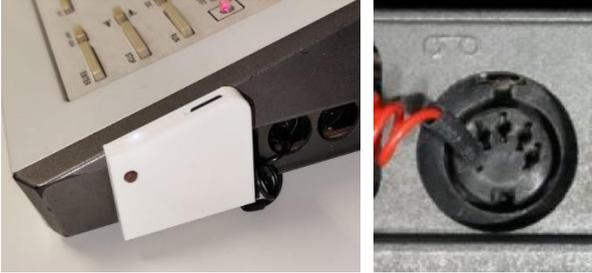
Die SD-Karte wird in den SD-Kartenschacht des SD-Moduls gesteckt. Damit ist das Modul einsatzbereit.
