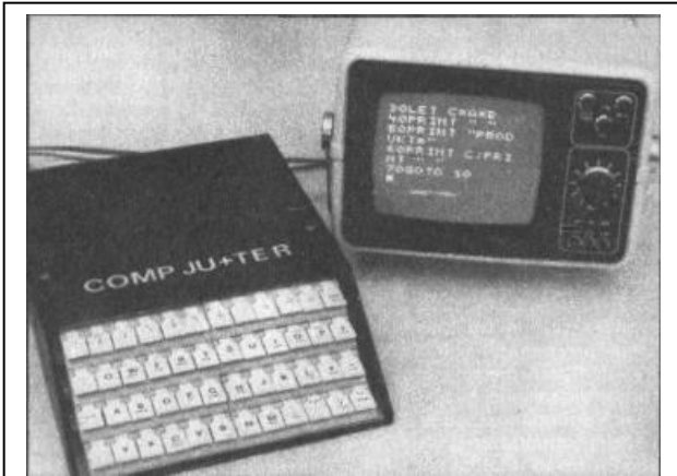
Ansicht des JU+TE-Computers mit Programmanzeige auf einem Mini-Fernsehempfänger
