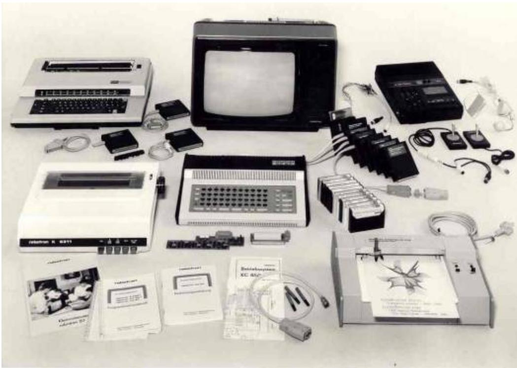
Z9001 mit allen Zusätzen (Werkfoto robotron)
