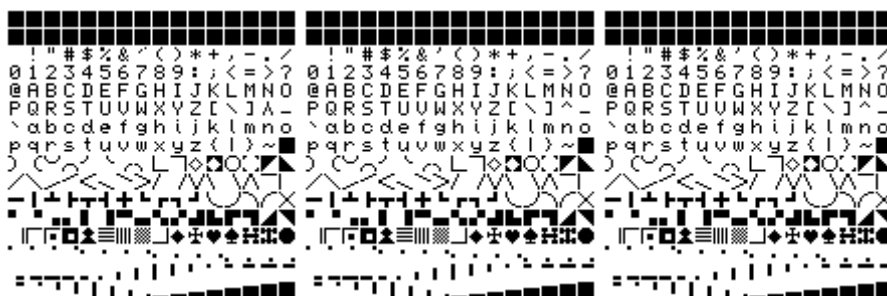
Zeichensatz KC85/1, KC87.1x, KC87.2x. Unterschiedlich sind die Zeichen ^ und e.
