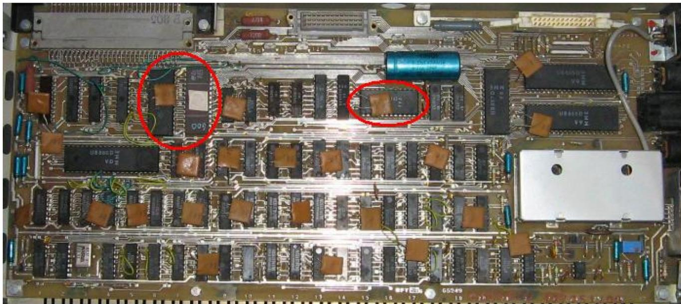
**KC87.21.** Deutlich sind links oben die großen (E)PROMs 600 und 608 anstelle der 5 größeren Schaltkreise des Z9001 zu sehen. Der Zeichensatz-PROM D66 (rechter roter Kreis) trägt die Kennung BM115. Beim KC87.1x ist hier ein PROM mit der Kennung BM111 eingebaut.
