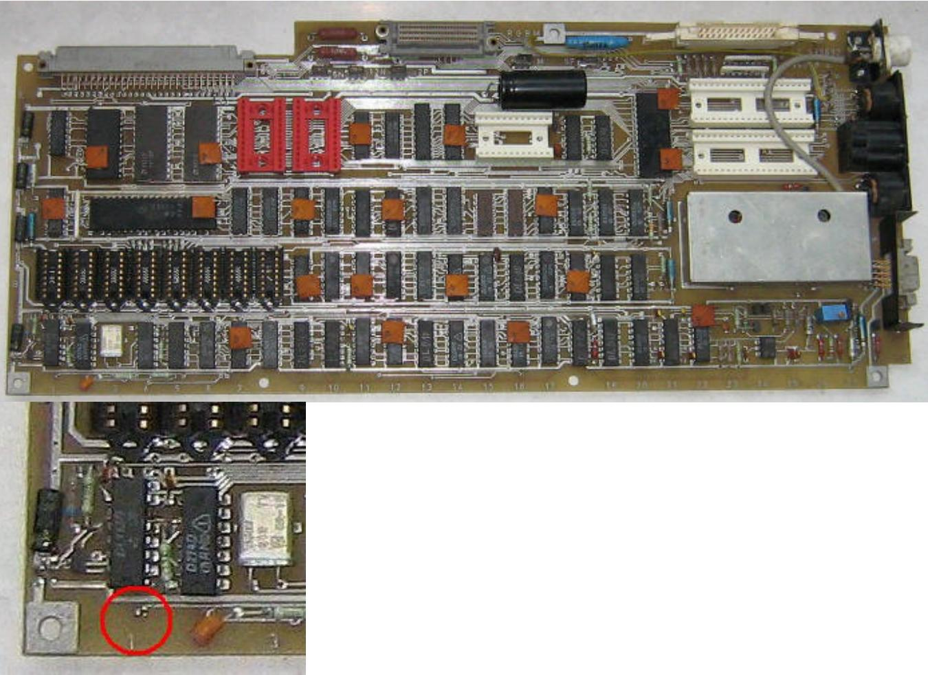
**Z9001, Serie 84.** Das einfachste Unterscheidungsmerkmal zur Serie 85 ist der fehlende Kondensator links unten an der Markierungsstelle 1. Die Serie 85 hat hier zwei Durchkontaktierungen, in denen ein zweiter Kondensator steckt.
