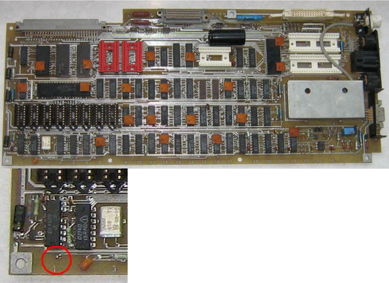
**Z9001, Serie 84.** Das einfachste Unterscheidungsmerkmal zur Serie 85 ist der fehlende Kondensator links unten an der Markierungsstelle 1. Die Serie 85 hat hier zwei Durchkontaktierungen mit einem Kondensator.
