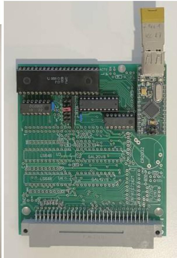
An das [VDIP1-Modul](#) wird ein USB-Stick angesteckt. Unterstützt werden USB 1.1 und USB 2.0-Sticks. Ein 8GB-Stick wurde erfolgreich getestet. Der Stick muss mit **FAT12, FAT16 oder FAT32** formatiert
