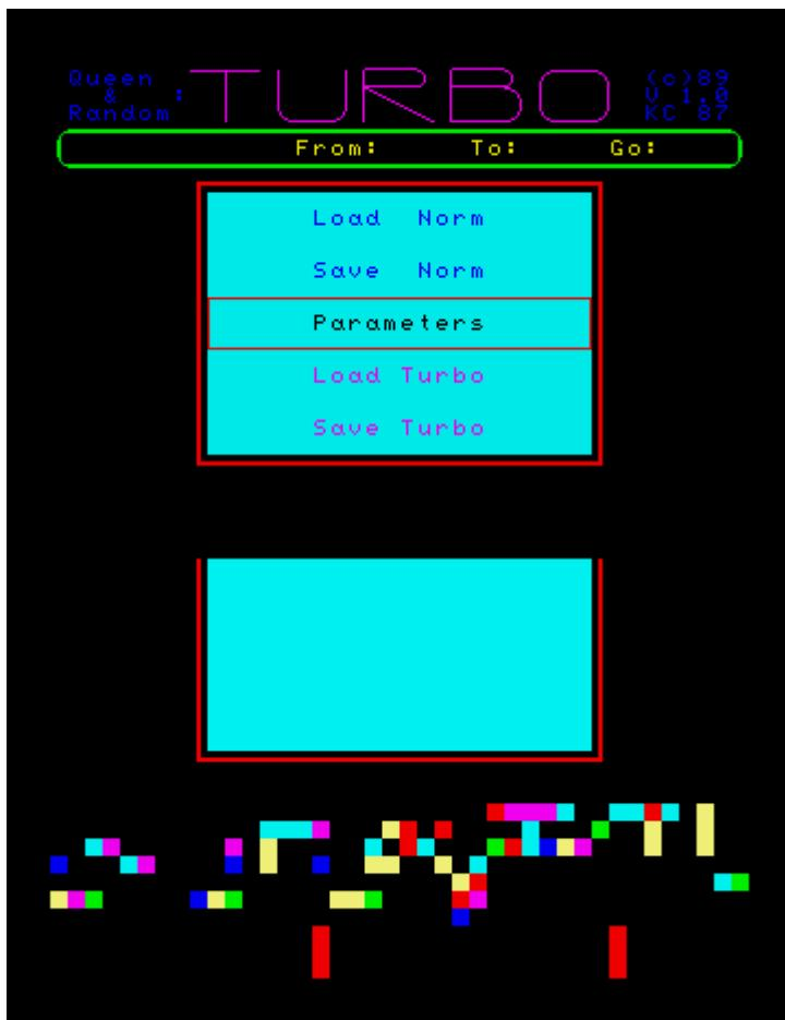
Der Turbo von Sven Huth ist das mit Abstand faszinierendste Programm für den Z9001: Ein Turbo-Loader, der mit normalem KC-Block-Load beginnt und unvermittelt in den Turbo-Modus übergeht. Dabei flackern am Rand Farbbalken, wie man es sonst nur von Turbo-Loadern vom ZX Spectrum oder C64 kennt.
