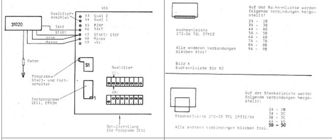
Anschluss Signaturanalysator an ASA
