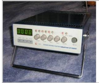
Signaturanalysator robotron 31020 (ohne Tastköpfe)
