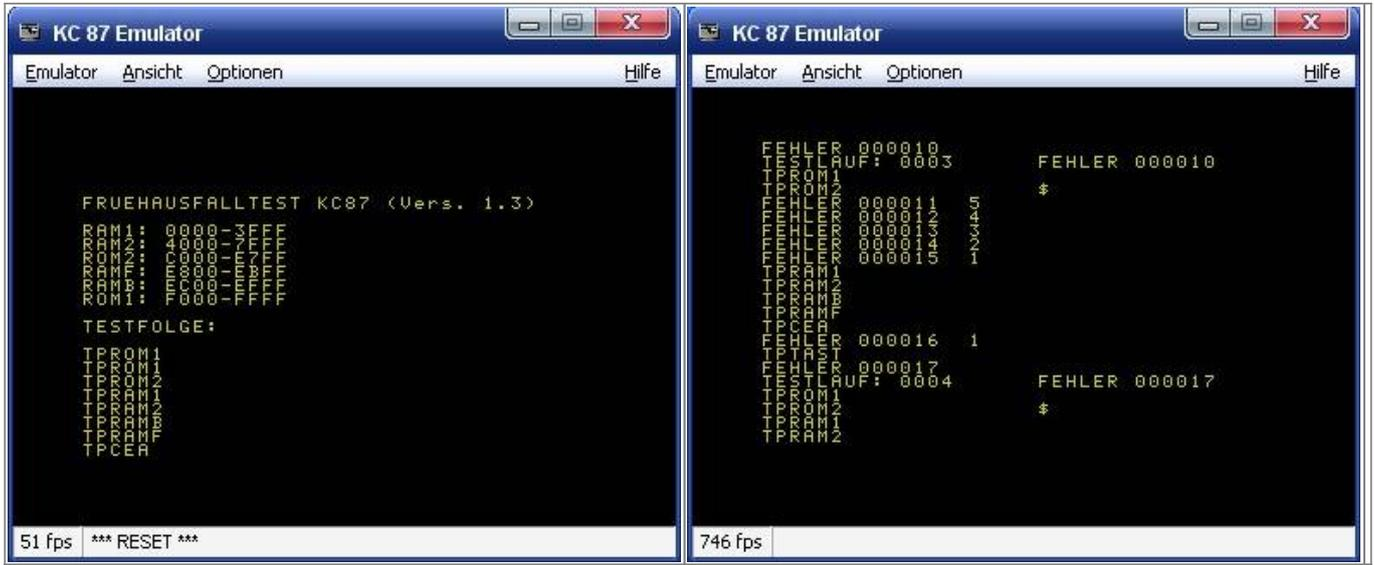
Frühausfalltest KC87, Start. Es werden die Speicherbereiche und die auszuführenden Tests angezeigt.
