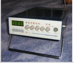
Signaturanalysator robotron 31020 (ohne Tastköpfe)
