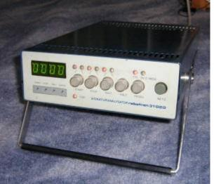
Signaturanalysator robotron 31020 (ohne Tastköpfe)
