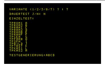
Gibt es bei einem Test Fehler, so wird lfd. Fehlernummer ausgegeben. Beim TPROM1/2-Test wird zusätzlich die Nummer des 2K-ROMs angegeben, in dem der Fehler aufgetreten ist.
