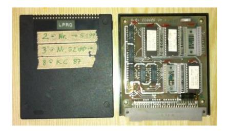
Das ROM-Modul LPRO basiert auf dem Frühausfalltest. Es ist aber umfangreicher. Es sind zwei Versionen bekannt: LPRO 1.5 und LPRO 1.6. Letzeres enthält Prüfsummen für den KC87.2x sowie Tests des IDAS-Moduls.
