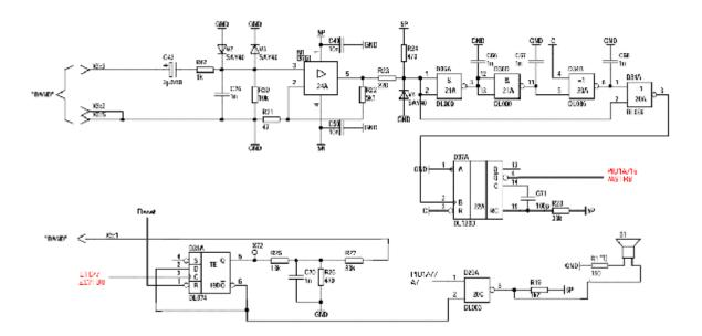
Beim **Lesen vom Kassettengerät** wird das Signal über ein Filter zum Operationsverstärker (24A) geführt, der das Signal in einen Rechteckimpuls umformt, der durch den nachfolgenden Widerstand und Diode (R24, V4) in ein TTL-Signal umgewandelt wird.
