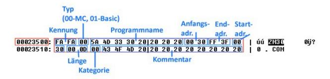
Der Beispiel-FA-Rahmen im Detail. Die tatsächliche Programmlänge entspricht nicht dem im Kassettenheader angegebenen Bereich bis 3FFF, sondern ist kürzer.
