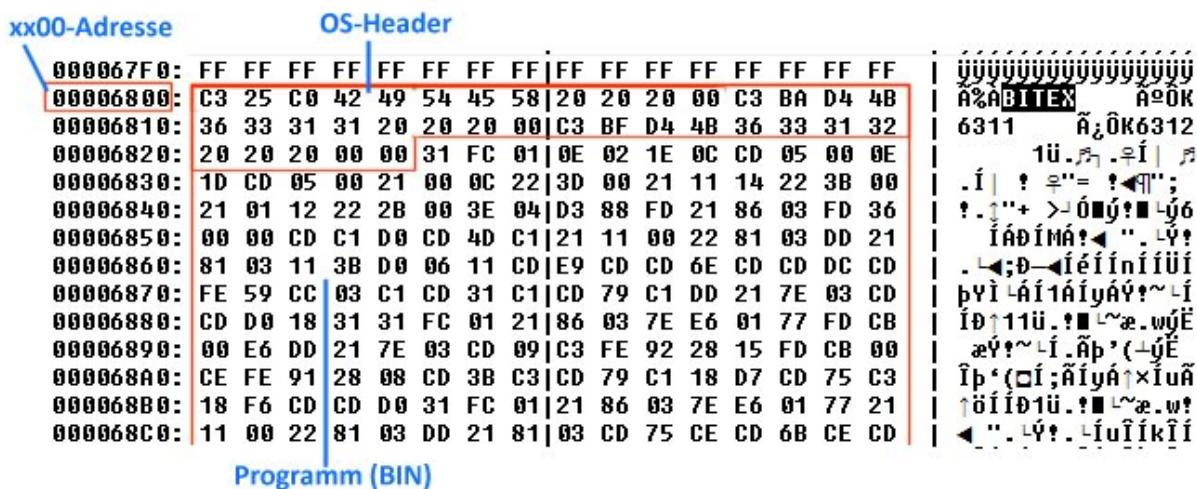
Beispiel für ein Programm mit OS-Rahmen. Hier stehen 3 Kommandos im OS-Rahmen. Die xx00-Adresse im EPROM muss mit der korrekten Lage im Z9001 korrespondieren (hier wäre das C000h).
