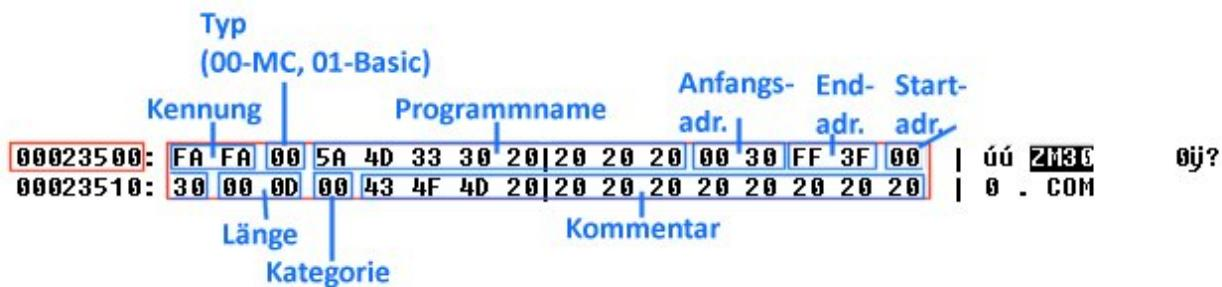
Der Beispiel-FA-Rahmen im Detail. Die tatsächliche Programmlänge entspricht nicht dem im Kassettenheader angegebenen Bereich bis 3FFF, sondern ist kürzer.
