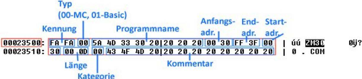
Der Beispiel-FA-Rahmen im Detail. Die tatsächliche Programmlänge entspricht nicht dem im Kassettenheader angegebenen Bereich bis 3FFF, sondern ist kürzer.
