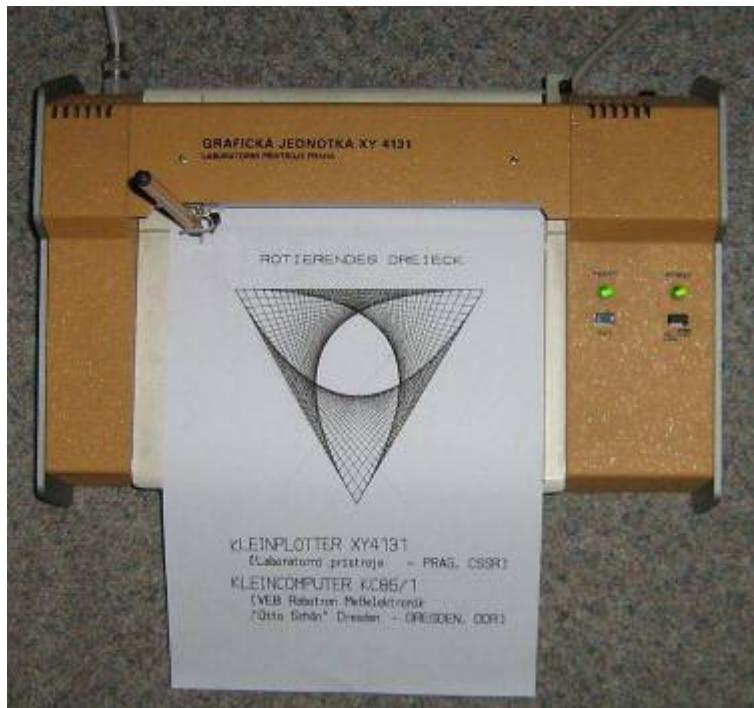
Die tschechischen Kleinplotter XY 4131 und XY 4140 lassen sich an den Z9001 anschließen und für grafische Ausgaben nutzen.
