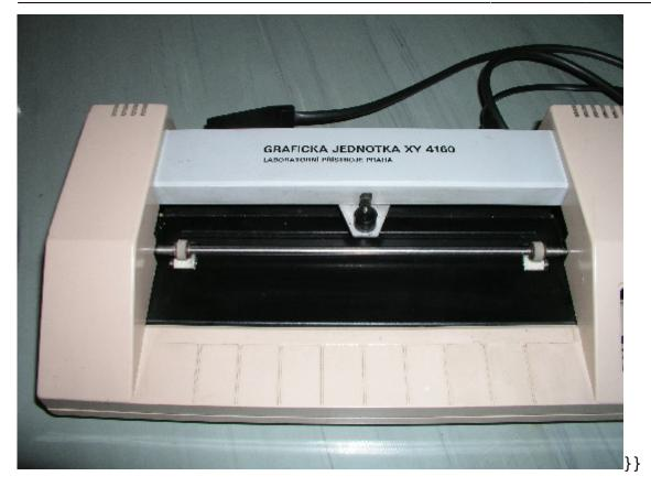
Die tschechischen Plotter XY4131b, XY 4140, XY 4150, XY 4160, die alle für den Betrieb am Z9001 geeignet sind. (Bilder mit freundlicher Genehmigung von http://www.digitron.cz/periferie.htm)
