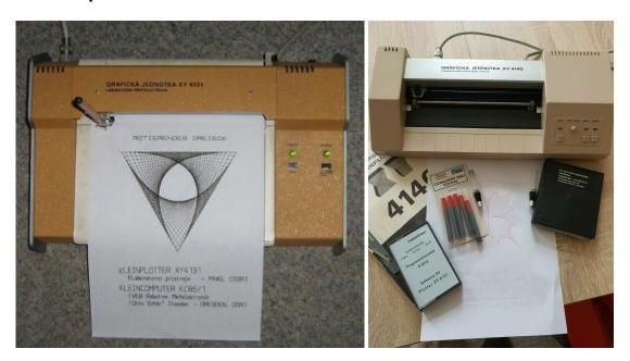
Die tschechischen Kleinplotter XY 4131 und XY 4140 lassen sich an den Z9001 anschließen und für grafische Ausgaben nutzen.
