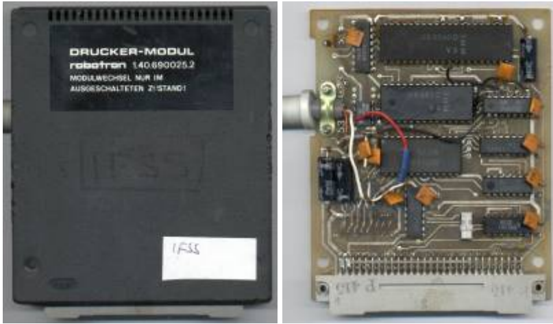
Umbau eines Drucker-Moduls 1.40.690025.2 auf eine IFSS-Schnittstelle
