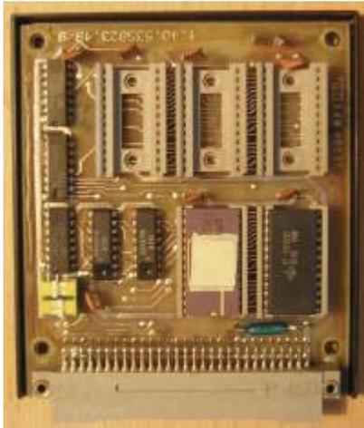
ROM/RAM-Modul-Umbau: der zweite Steckplatz des ROM-Moduls enthält einen SRAM 6516 und ist damit beschreibbar.
