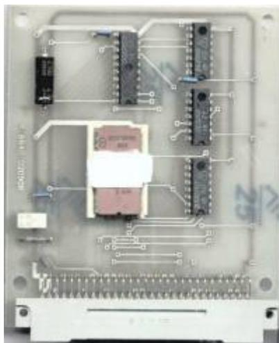
Abschaltbarer ROM-Modul, der den sogenannten „Urlader“ enthält, mit dem das Betriebssystem von der Systemdiskette in den RAM-Speicher geladen wird. Nach Laden des Betriebssystems wird er abgeschaltet.
