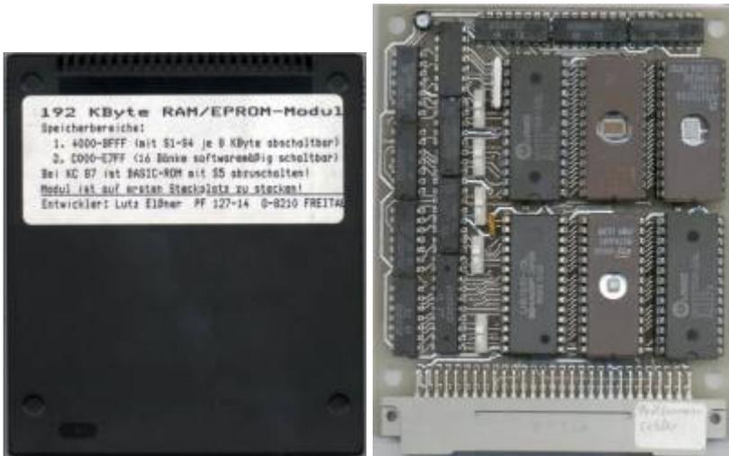
Ein Universal-RAM-ROM-Modul, 80k RAM, 112K ROM, ersetzt 2 RAM-Module und alle ROM-Module (BASIC, ASM, IDAS, ...) gleichzeitig
