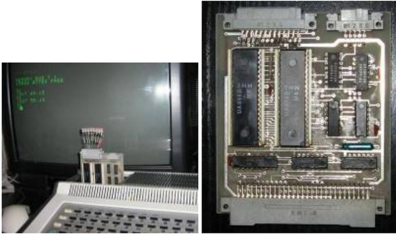
Das Modul wird ausführlich auf [http://www.z1013.de/ea\\_modul.html](http://www.z1013.de/ea_modul.html) beschrieben. Es funktioniert am Z9001 ohne Änderungen. Im linken Bild stecken 8 LEDs verteilt auf die drei PIO-Ports, mittels BASIC werden die 5 rechten LED aktiviert (Lo-Anzeige)
