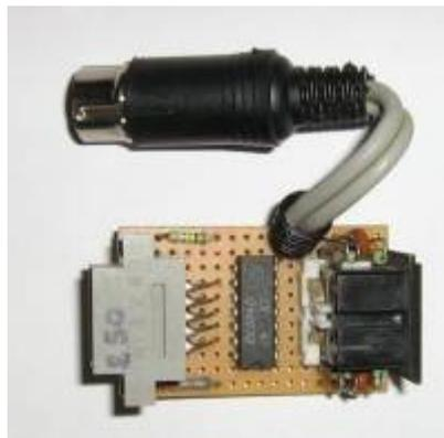
3stimmige Soundausgabe über den Kassettenrecorder, Entwicklung von Robotron. Schaltung gibt's bei [U. Zander](#)
