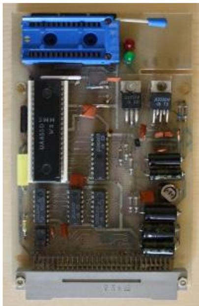
Eine Urversion des Eprom-Programmier-Moduls. Im Gegensatz zur finalen Version hat dieses Exemplar nur 1 Spannungsregler-IC.
