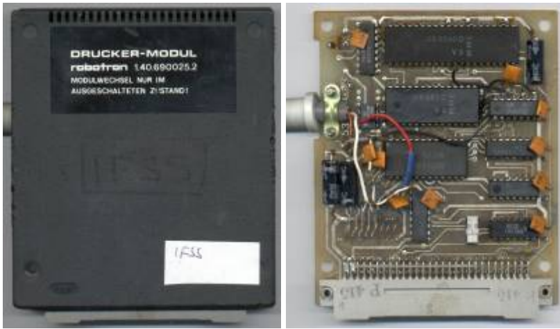
Umbau eines Drucker-Moduls 1.40.690025.2 auf eine IFSS-Schnittstelle
