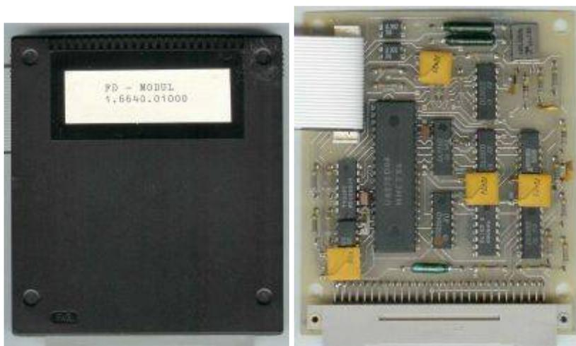
Der FD-Modul realisiert die Schnittstelle zwischen Diskettenlaufwerk(en) und KC. Kernstück ist der Floppy-Disk-Controller (FDC). Mit dem FD-Modul können 1 oder 2 Diskettenlaufwerke für 5¼-Zoll-Disketten mit 80 Spuren je Seite, zweiseitiger Aufzeichnung und doppelter Aufzeichnungsdichte betrieben werden.
