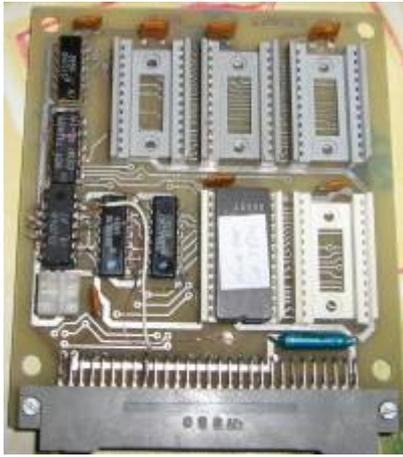
mit diesem Umbau wird ein ROM-Modul kompatibel zum BOOT-Modul der CP/M-Module. Der Aufwand beschränkt sich auf einen DL074.
