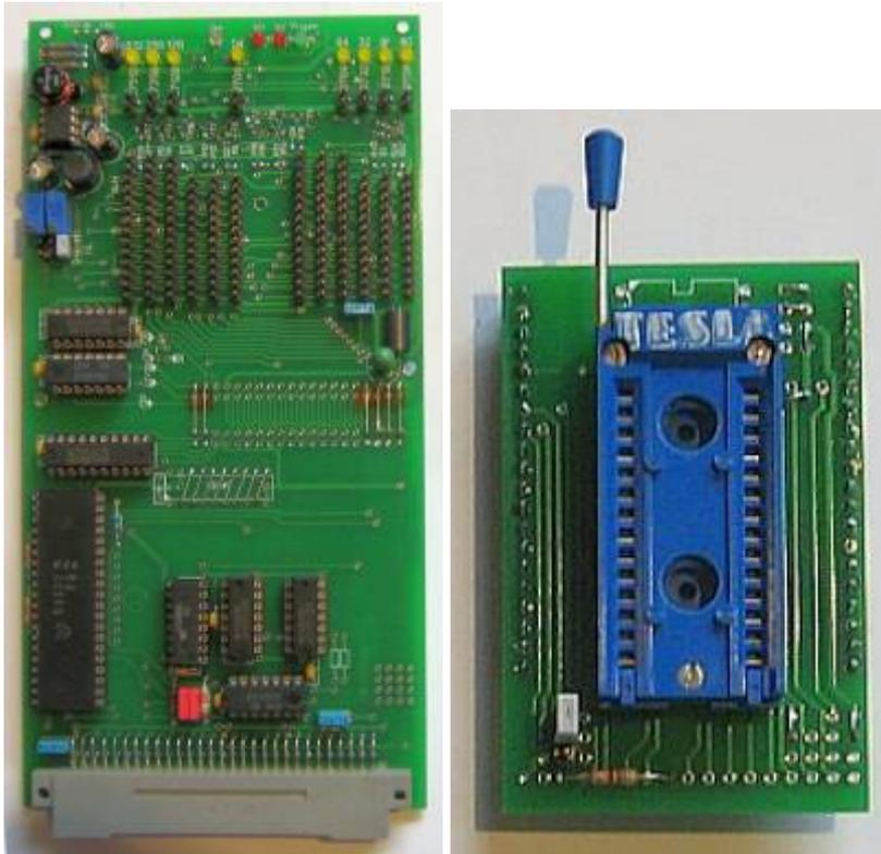
Ein EPROM-Brenner für 2704..27512. Der Brenner ist software- und funktionskompatibel zum [Eprommer des CC Leipzig](#) (f. Z1013). Der EPROM steckt auf einen extra Adapter. Dieser wird je nach Typ auf der Hauptplatine aufgesteckt. Die Brennsoftware ist auf dem Megamodul verfügbar. Beschreibung auf [Bübchens Homepage](#).
