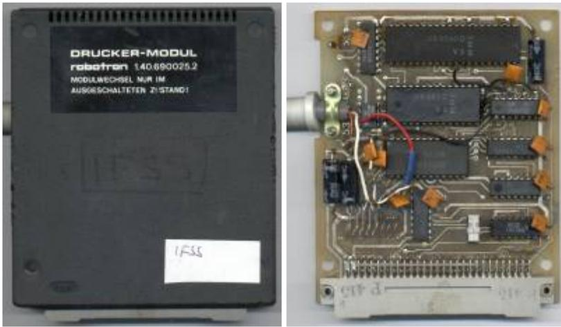
Umbau eines Drucker-Moduls 1.40.690025.2 auf eine IFSS-Schnittstelle
