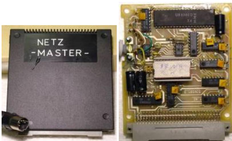
Das Modul entspricht dem Slave-Modul. Zusätzlich ist ein Taktgenerator mit B555 enthalten. Leider ist über den Verbleib des Moduls und weitere Software nichts bekannt. Ein paar Infos zum Netzwerk NETZ 2 gibt es auf [robotrontechnik.de](http://robotrontechnik.de)
