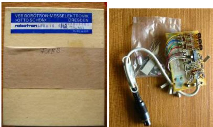
Der Farbzusatz (vergleichbar mit einer SCART-Buchse) musste von einer Fachwerkstatt in den Fernseher eingebaut und mit dem konkreten Z9001 abgeglichen werden, ehe eine Farbdarstellung von Z9001 aus möglich war.
