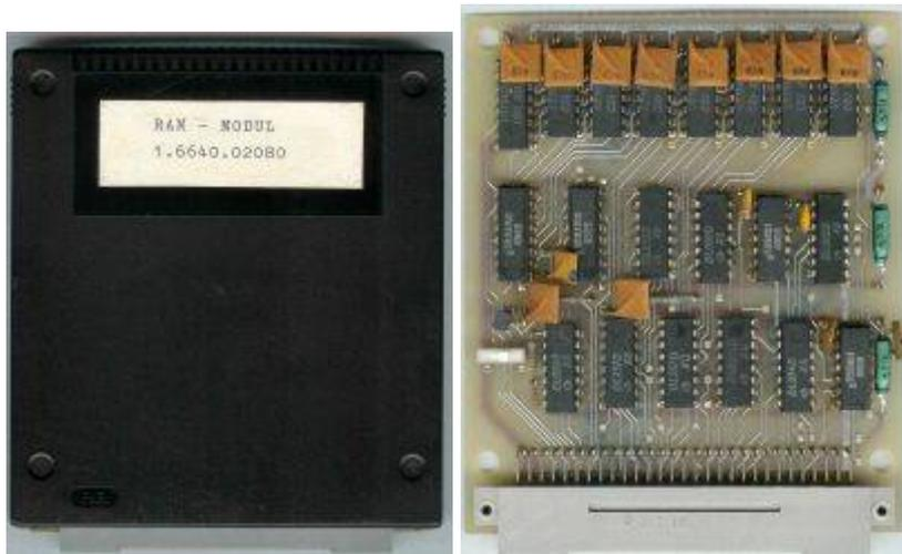
Er enthält 8 DRAM-Schaltkreise 64k x 1 Bit. Der Bereich der unteren 16 kBytes wird als Speicherbank dem Bereich 4000H bis 7FFFH parallel gelegt (Schatten-RAM).
