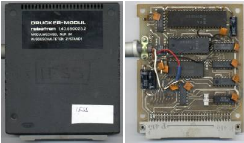
Umbau eines Drucker-Moduls 1.40.690025.2 auf eine IFSS-Schnittstelle
