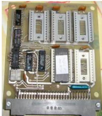
mit diesem Umbau wird ein ROM-Modul kompatibel zum BOOT-Modul der CP/M-Module. Der Aufwand beschränkt sich auf einen DL074.
