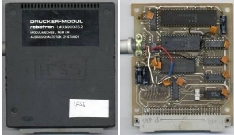
Umbau eines Drucker-Moduls 1.40.690025.2 auf eine IFSS-Schnittstelle
