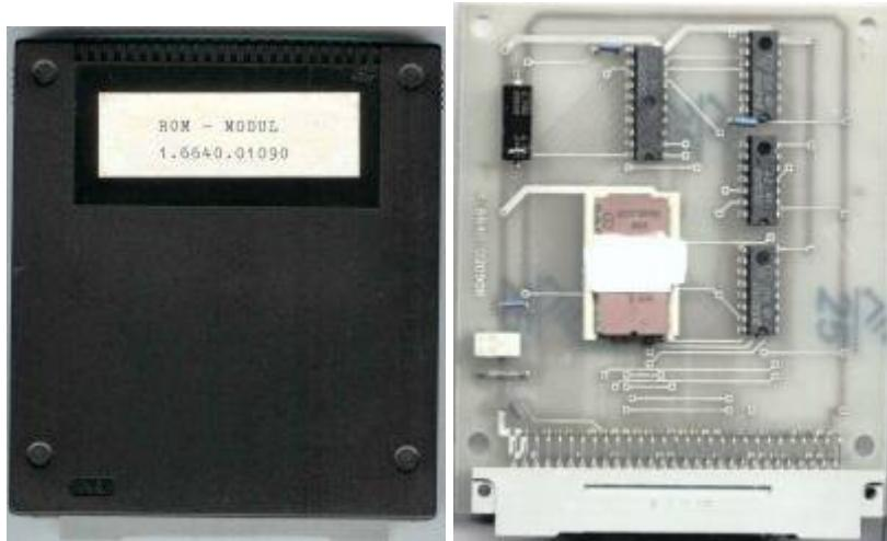
Abschaltbarer ROM-Modul, der den sogenannten „Urlader“ enthält, mit dem das Betriebssystem von der Systemdiskette in den RAM-Speicher geladen wird. Nach Laden des Betriebssystems wird er abgeschaltet.
