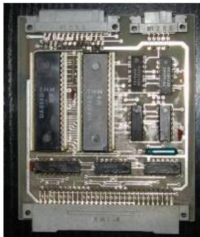
Das Modul wird ausführlich auf [http://www.z1013.de/ea\\_modul.html](http://www.z1013.de/ea_modul.html) beschrieben. Es funktioniert am Z9001 ohne Änderungen. Im linken Bild stecken 8 LEDs verteilt auf die drei PIO-Ports, mittels BASIC werden die 5 rechten LED aktiviert (Lo-Anzeige)
