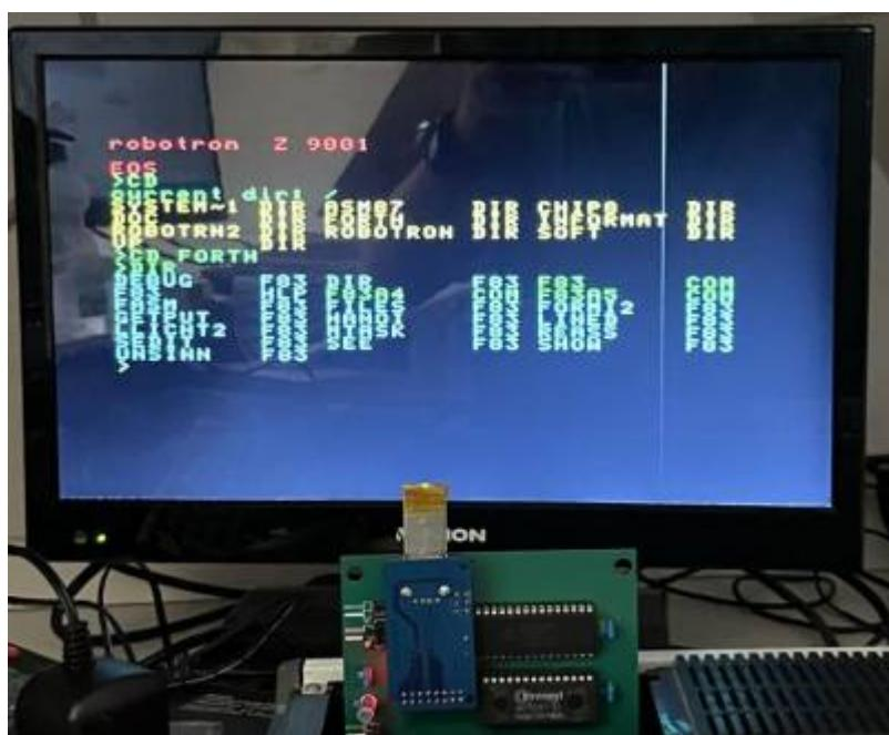
Seit einigen Jahren gibt es mit dem CH376 eine Alternative zum VDIP-USB-Interface. Der CH376 ist ein Mikrocontroller für USB-Speicher und SD-Karten.
