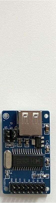
einfaches Modul,nur CH376-Aufsatz, Platine von „felge“, und das benötigte USB-CH376-Modul
