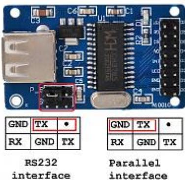
**Achtung:** Es gibt ähnliche „CH376S U DISK READ WRITE MODULE“, die aber eine andere Steckverbinderbelegung und auch nur einen 3pol. Jumper haben. Diese Module können NICHT mit dieser Leiterplatte verwendet werden!
