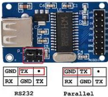
**Achtung:** Es gibt ähnliche „CH376S U DISK READ WRITE MODULE“, die aber eine andere Steckverbinderbelegung und auch nur einen 3pol. Jumper haben. Es gibt auch einen Reset-Pin. Das muss bei der Verdrahtung beachtet werden!
