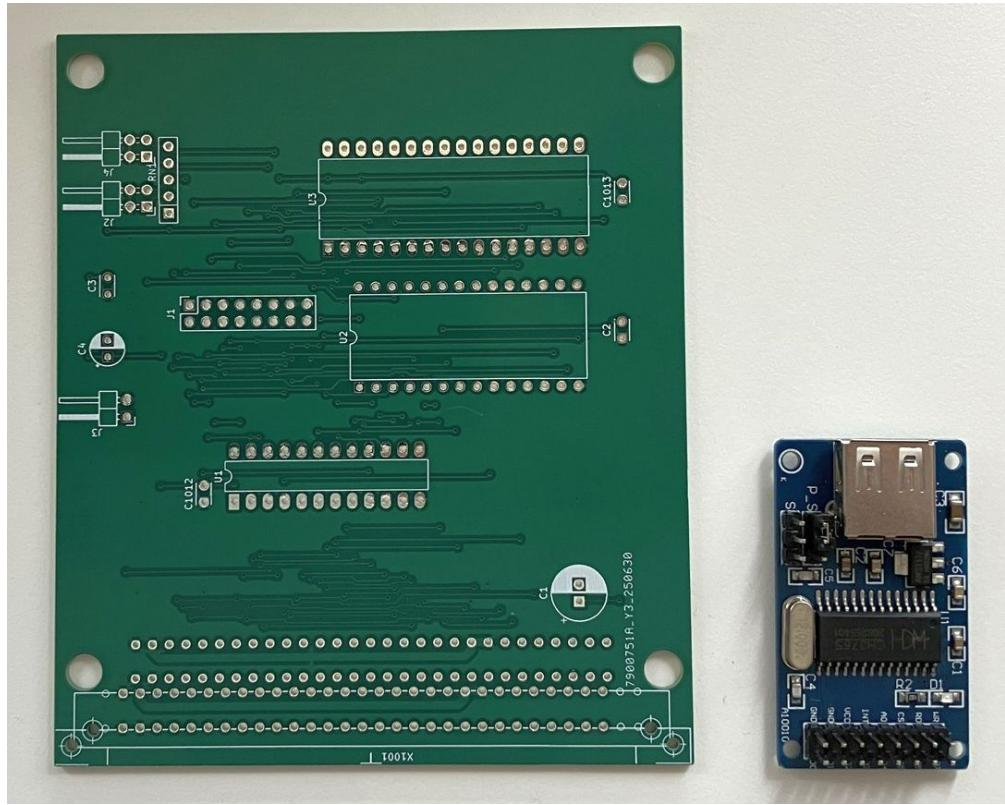
einfaches Modul, nur CH376-Aufsatzt, Platine von „felge“, und das benötigte USB-CH376-Modul
