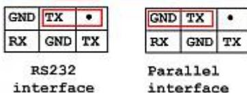
**Achtung:** Es gibt ähnliche „CH376S U DISK READ WRITE MODULE“, die aber eine andere Steckverbinderbelegung und auch nur einen Jumper haben. Es gibt auch einen Reset-Pin. Das muss bei der Verdrahtung beachtet werden!
