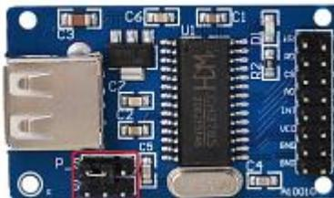
**Achtung:** Es gibt ähnliche Module, die aber eine andere Steckverbinderbelegung und auch nur einen Jumper haben. Das muss bei der Verdrahtung beachtet werden! Die meisten der bei ebay angebotenen „CH376S U DISK READ WRITE MODULE“ sind von dieser folgenden Variante:
