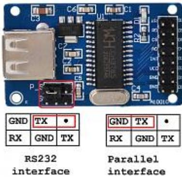
**Achtung:** Es gibt ähnliche Module, die aber eine andere Steckverbinderbelegung und auch nur einen Jumper haben. Das muss bei der Verdrahtung beachtet werden! Die meisten der bei ebay angebotenen „CH376S U DISK READ WRITE MODULE“ sind von dieser folgenden Variante:
