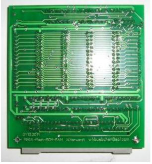
Vorder- und Rückseite Modul Serie 1.10.2011. Hier mit 5 EPROMs bestückt. Bei Nutzung von FLASH-Speicher muss das Steckfeld oben links anders belegt werden. In dieser Serie war noch eine kleine Änderung nötig (Drahtbrücke auf Leiterseite von Jumper an Steckverbinder B9 statt an B27).
