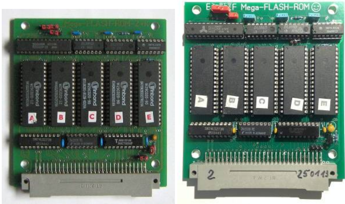
Serie 2013 mit 32K-RAM li. Version Z+K 29.04.2013, rechts Mega-Flash-ROM 03.01.2013
