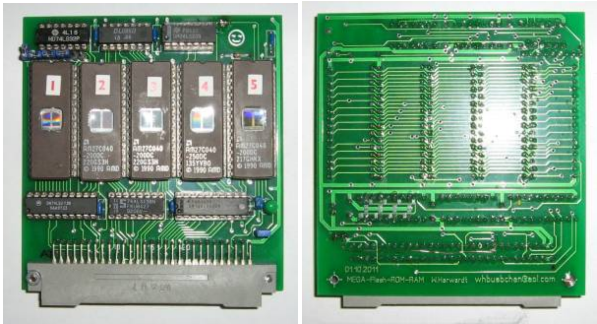
Vorder- und Rückseite Modul Serie 1.10.2011. Hier mit 5 EPROMs bestückt. Bei Nutzung von FLASH-Speicher muss das Steckfeld oben links anders belegt werden. In dieser Serie war noch eine kleine Änderung nötig (Drahtbrücke auf Leiterseite von Jumper an Steckverbinder B9 statt an B27).
