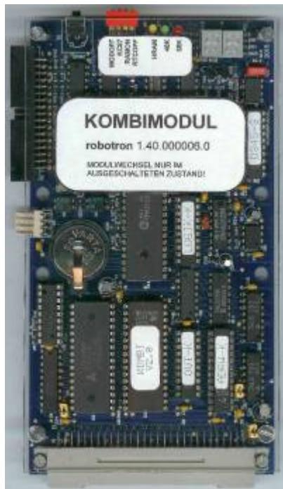
Das Kombi-Modul ist eine Entwicklung von U. Zander (<http://www.sax.de/~zander/z9001/module/kombi.html>). Es umfasst 4 einzelne Komponenten auf einer 95 mm x 170 mm großen Leiterplatte (Modul-Format wie Programmier-Modul):
