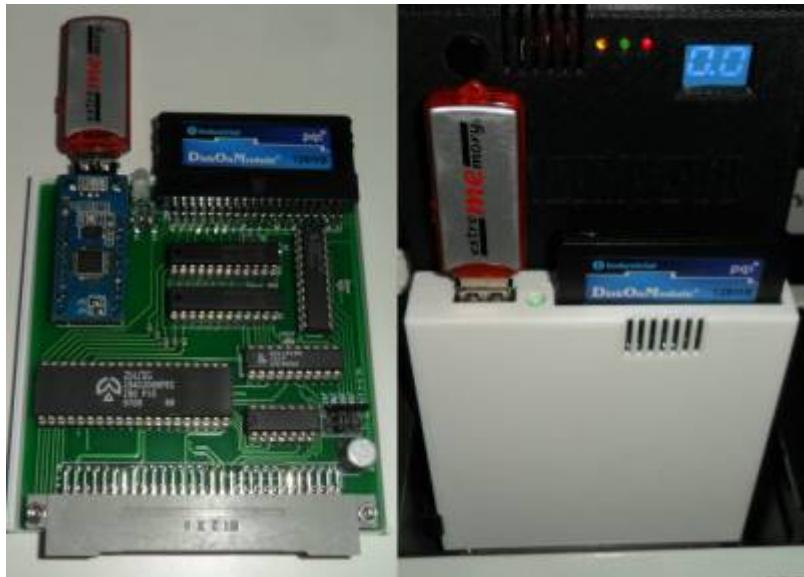
Im Gegensatz zur [GIDE+USB+RTC-Modul](#) ist die RTC entfallen; die Leiterplatte ist aber übersichtlicher und leichter zu bestücken. Für das DOM-Modul braucht man kein extra Kabel, es wird direkt oben ans Modul gesteckt.
