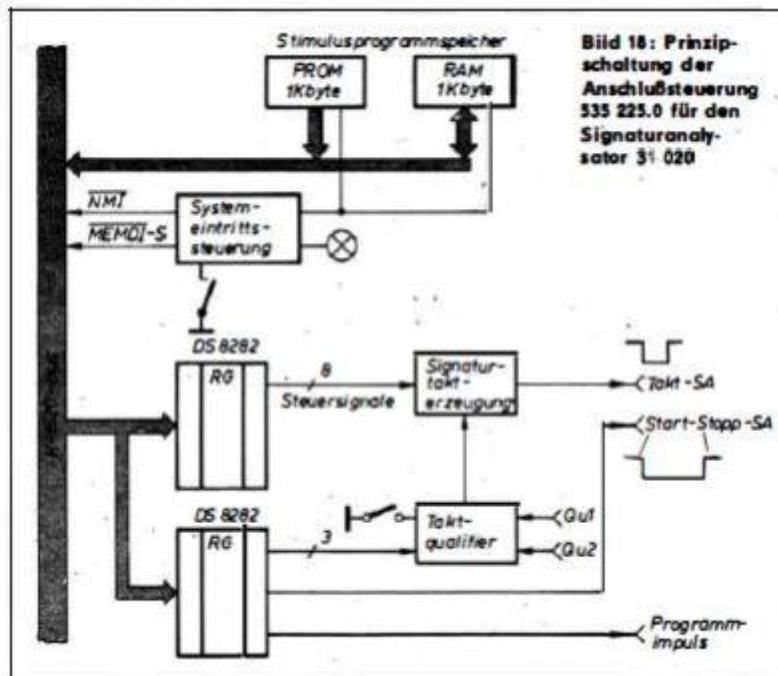
Anschluss Signaturanalysator an ASA, aus der Reparaturanleitung des Z9001; rechts: Bild 18
