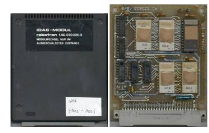
Neue ROM-Leiterplatte (mit Abschaltmöglichkeit für KC 87) Im IDAS-Modul enthalten ist auch die Software für das Programmier-Modul.
