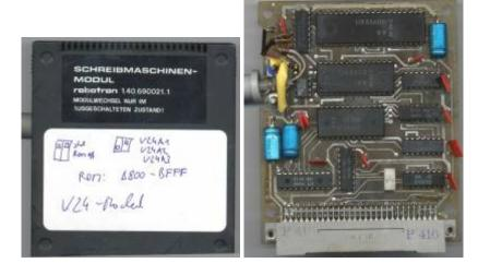
bis III 87: ROM M012. ROM U2616D45 BM116: enthält Programme V24A1, V24A2, V24A3. Doku bei U. Zander
