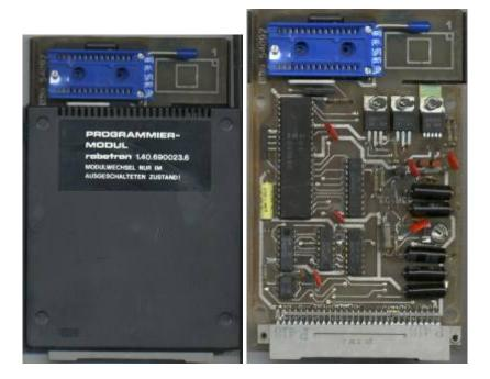
Zum Programmiermodul gab es den EPROM M502 mit der Brennsoftware dazu. (zu sockeln im ROM-Modul für Adresse A000 bzw. E000)Dokumentation, Sourcecode
