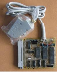
ROM U2616D45 BM112, bis III 87: ROM M013. Die Druckermodule unterscheiden sich nur im PROM und dem Steckverbinder, nicht in der HardwareDokumentation (alt, bis II 87) Dokumentation neu → U.Zander
