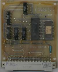
Das Basic-Modul mit den Erweiterungen für den Plotter XY3130 oder das Vollgrafikmodul.
