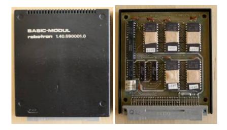
Alte ROM-Leiterplatte (Typ A), Gehäuse direkt bedruckt
