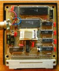
Die Druckermodule unterscheiden sich nur im PROM und dem Steckverbinder, nicht in der Hardware. enthält EPROM M506
