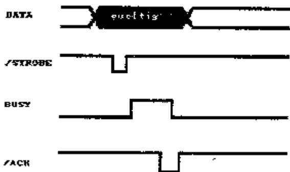
Bild 6 zeigt das Signalverhalten. Da die Pegel TTL-Pegel sind, eignet sich dieses Interface besonders gut für den Betrieb am User-Port des KC 85/1. Bestimmte Einschränkungen müssen allerdings wegen der begrenzten Zahl der Datenleitungen wieder getroffen werden. Will man gänzlich ohne Zusatzhardware auskommen, so bietet sich eine Zuordnung der Signale des User-Ports zu den CENTRONICS-Signalen in folgender Form an:
