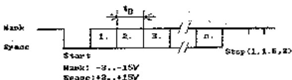
Geräteschnittstelle betrachtet. Detailliertere Informationen zu dem Standard können u. a. /2/ entnommen werden. Computer- Peripheriegeräte mit dieser Schnittstelle arbeiten in der Regel mit einem asynchronen Übertragungsprotokoll nach Bild 3. Dieses Übertragungsprotokoll erlaubt eine große Flexibilität bzgl. bestimmter Parameter:
