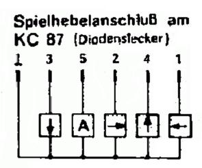
Anschlusskabel. Die Nummern entsprechen den Nummern im Diodenstecker (von innen auf die Kontakte gesehen von links nach rechts 1-4-2-5-3), Leitung 6 geht an die Abschirmung.
