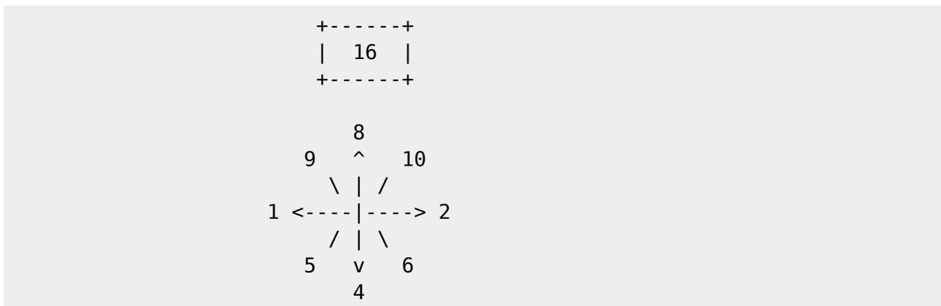
Unter BASIC wird der Spielhebel mit der Funktion JOYST(1) bzw. JOYST(2) abgefragt. Rückgabewert ist obiger Wert 0..16. Weitere Details zur Abfrage s. BASIC-Programmierhandbuch, Abschnitt 4.14.
