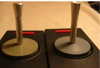
Der Z9001.10 bietet die Möglichkeit, direkt 2 Spielhebel anzuschließen. Bei der Farbvariante und dem Nachfolger KC 87 kann man dagegen nur einen Spielhebel anschließen; der zweite Anschluss wurde zur RGB-Buchse (für Anschluss Farb-TV). Will man an einem solchen Gerät zwei Spielhebel nutzen, benötigt man einen Spielhebel-Adapter 1.40.690019.7 (s.u.).
