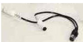
Der Spielhebeladapter dient zum Anschluss von 2 Spielhebeln an die Farbvariante. Er ist einfach ein Y-Kabel mit einem 7 pol. Diodenstecker und zwei Diodenbuchsen, in dem die Leitungen 1-5 an beide Diodenbuchsen durchgereicht werden. Abschirmung und Anschluss X4:7 gehen an die Abschirmung
