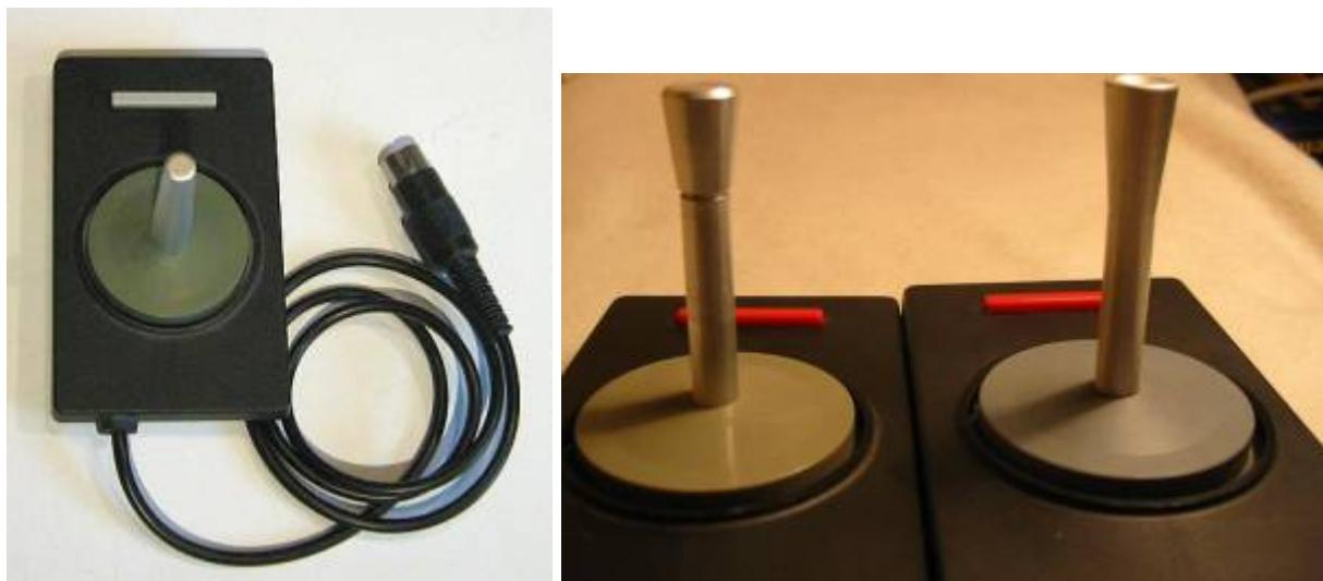
Der Z9001.10 bietet die Möglichkeit, direkt 2 Spielhebel anzuschließen. Bei der Farbvariante und dem Nachfolger KC 87 kann man dagegen nur einen Spielhebel anschließen; der zweite Anschluss wurde zur RGB-Buchse (für Anschluss Farb-TV). Will man an einem solchen Gerät zwei Spielhebel nutzen, benötigt man einen Spielhebel-Adapter 1.40.690019.7 (s.u.).
