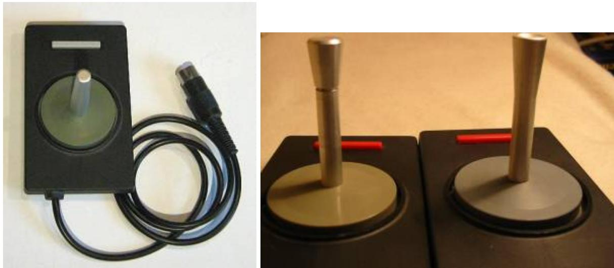
Der Z9001.10 bietet die Möglichkeit, direkt 2 Spielhebel anzuschließen. Bei der Farbvariante und dem Nachfolger KC 87 kann man dagegen nur einen Spielhebel anschließen; der zweite Anschluss wurde zur RGB-Buchse (für Anschluss Farb-TV). Will man an einem solchen Gerät zwei Spielhebel nutzen, benötigt man einen Spielhebel-Adapter 1.40.690019.7 (s.u.).
