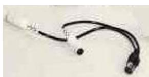
Der Spielhebeladapter dient zum Anschluss von 2 Spielhebeln an die Farbvariante. Er ist einfach ein Y-Kabel mit einem 7 pol. Diodenstecker und zwei Diodenbuchsen, in dem die Leitungen 1-5 an beide Diodenbuchsen durchgereicht werden. Abschirmung und Anschluss X4:7 gehen an die Abschirmung der Diodenbuchse für Spielhebel 1, Anschluss X4:6 geht an die Abschirmung der Diodenbuchse für
