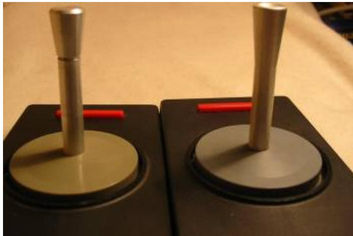
Der Z9001.10 bietet die Möglichkeit, direkt 2 Spielhebel anzuschließen. Bei der Farbvariante und dem Nachfolger KC 87 kann man direkt nur einen Spielhebel anschließen; der zweite Anschluss wurde zur RGB-Buchse (für Anschluss Farb-TV). Will man an einem solchen Gerät zwei Spielhebel nutzen, benötigt man einen Spielhebel-Adapter 1.40.690019.7.
