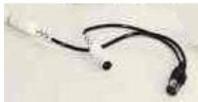
Der Spielhebeladapter dient zum Anschluss von 2 Spielhebeln an die Farbvariante. Er ist einfach ein Y-Kabel mit einem 7 pol. Diodenstecker und zwei Diodenbuchsen, in dem die Leitungen 1-5 an beide Diodenbuchsen durchgereicht werden. Abschirmung und Anschluss X4:7 gehen an die Abschirmung der Diodenbuchse für Spielhebel 1, Anschluss X4:6 geht an die Abschirmung der Diodenbuchse für Spielhebel 2.
