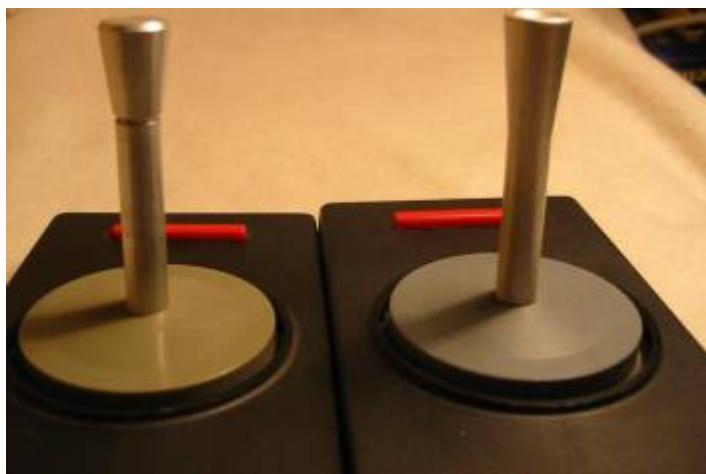
Der Z9001.10 bietet die MÃ¶glichkeit, direkt 2 Spielhebel anzuschließen. Bei der Farbvariante und dem Nachfolger KC 87 kann man direkt nur einen Spielhebel anschließen; der zweite Anschluss wurde zur RGB-Buchse (fÃ¼r Anschluss Farb-TV). Will man an einem solchen Gerät zwei Spielhebel nutzen, benötigt man einen Spielhebel-Adapter 1.40.690019.7.
