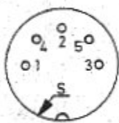
X 1 , auf Lötanschlüsse gesehen (gehört zu KABEL ,KPL. 1.40.535746.4 )
