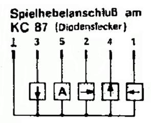
Anschlusskabel. Die Nummern entsprechen den Nummern im Diodenstecker (von innen auf die Kontakte gesehen von links nach rechts 1-4-2-5-3), Leitung 6 geht an die Abschirmung. Die Nummern auf der Leiterplatte entsprechen nicht ganz den Anschlüssen im Diodenstecker, hoch und runter sind vertauscht (3 und 4), s.a. orig. Schaltung:
