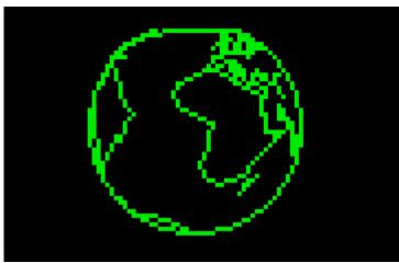
Grafik-Treiber GRAF14 für Auflösung 80×48 "Pixel". Im Download-Paket ist auch eine angepasste Version des Uhrenprogramms UHR14.; Das Globus-Programm, skaliert auf 80×48 Pixel.
