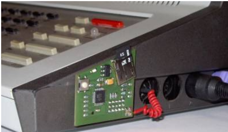
neue Version mit Micro-SD-Card und ATmega328p, Bild Kingstener
