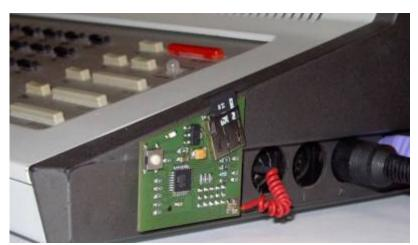
neue Version mit Micro-SD-Card und ATMega328p, Bild Kingestener
