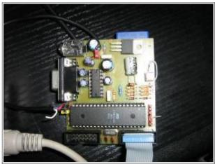
Die Leiterplatte. Am z9001 kann fast alles oberhalb des Mikrocontrollers entfallen. Die Fassung für die SD-Karte ist auf der Leiterseite. Die SD-Karte schaut oben hervor (blau).
