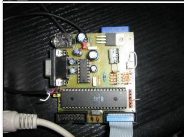
Die Leiterplatte. Am z9001 kann fast alles oberhalb des Mikrocontrollers entfallen. Die Fassung für die SD-Karte ist auf der Leiterseite. Die SD-Karte schaut oben hervor (blau).
