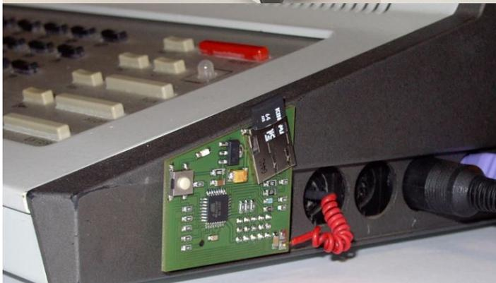
2024er Version mit Micro-SD-Card und ATmega328p, rechts Version 2013 (re.Bild + Video: Kingstener)
